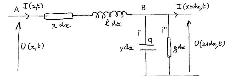
où  $r$ ,  $\ell$ ,  $\gamma$  et  $g$  désignent respectivement une résistance, une inductance, une capacité et une conductance *linéiques*.
